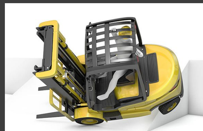
Risco de capotamento (empilhadores)
